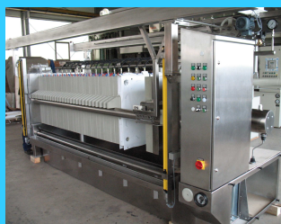
Filterpresse in Edelstahl für Lebensmittel
